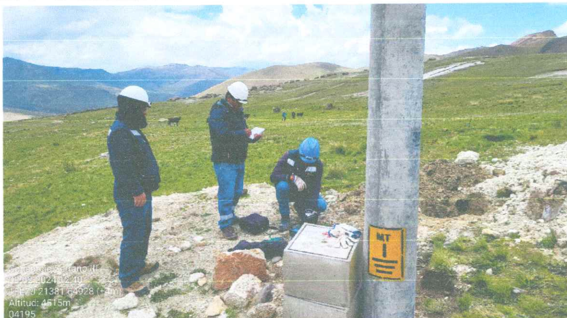
Foto N° 15: Medición de sistema de puesta a tierra SED ISCUIYO
