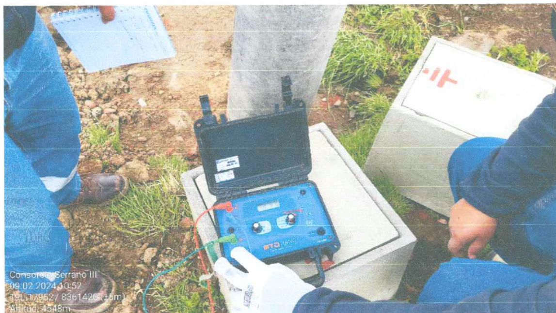
Foto N° 18: Valor de la medición e sistema de puesta a tierra SED PUKUNCHO 5.75 OHM.
