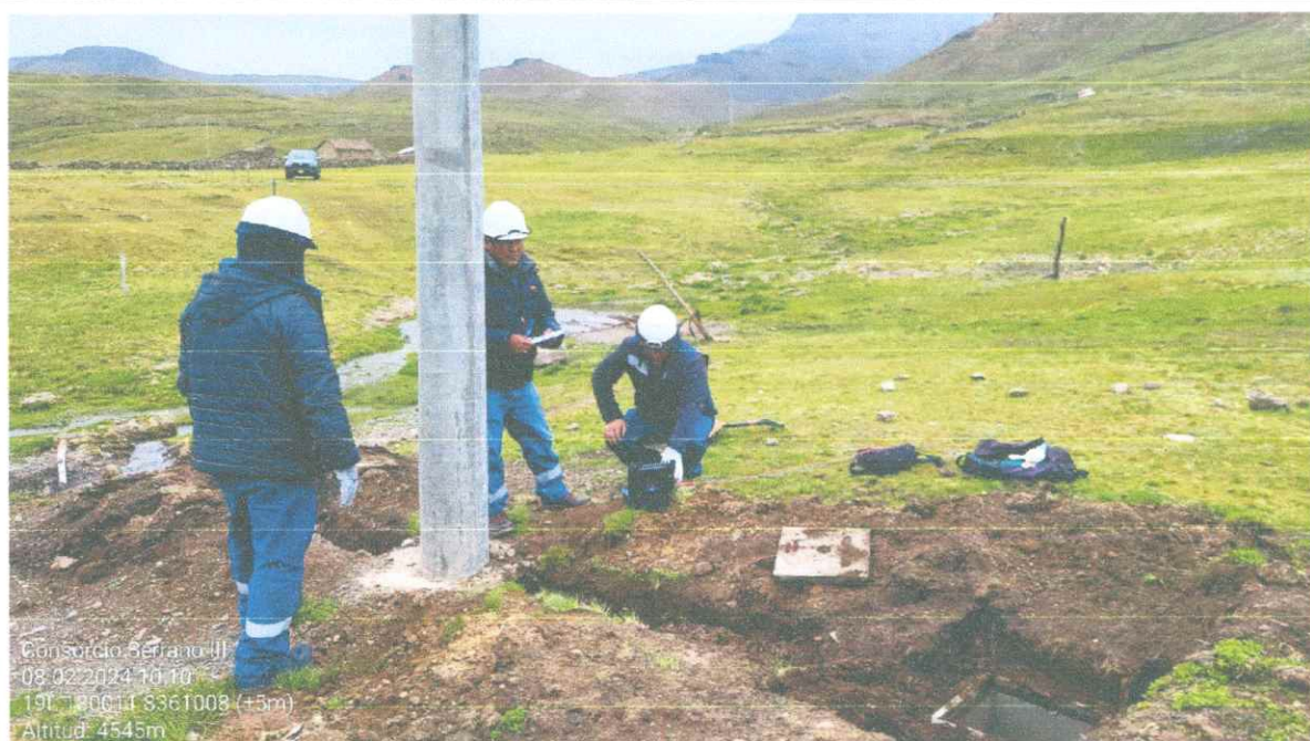
Foto N° 14: Medición de sistema de puesta a tierra – SED CHAIÑA .
