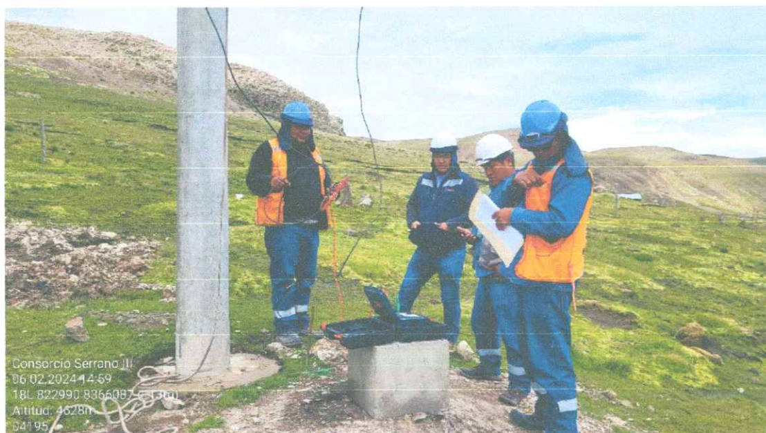
Foto N° 10: Medición de aislamiento línea primaria tramo Iscuyo
