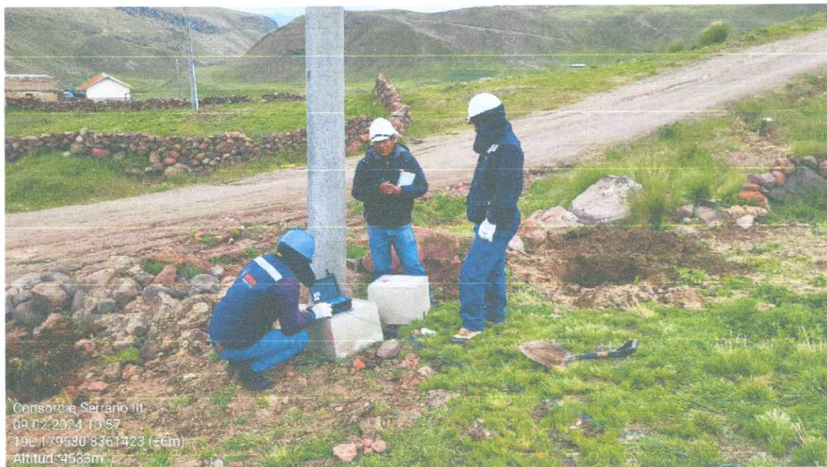
Foto N° 17: Medición de sistema de puesta a tierra sector PUKUNCHO.
