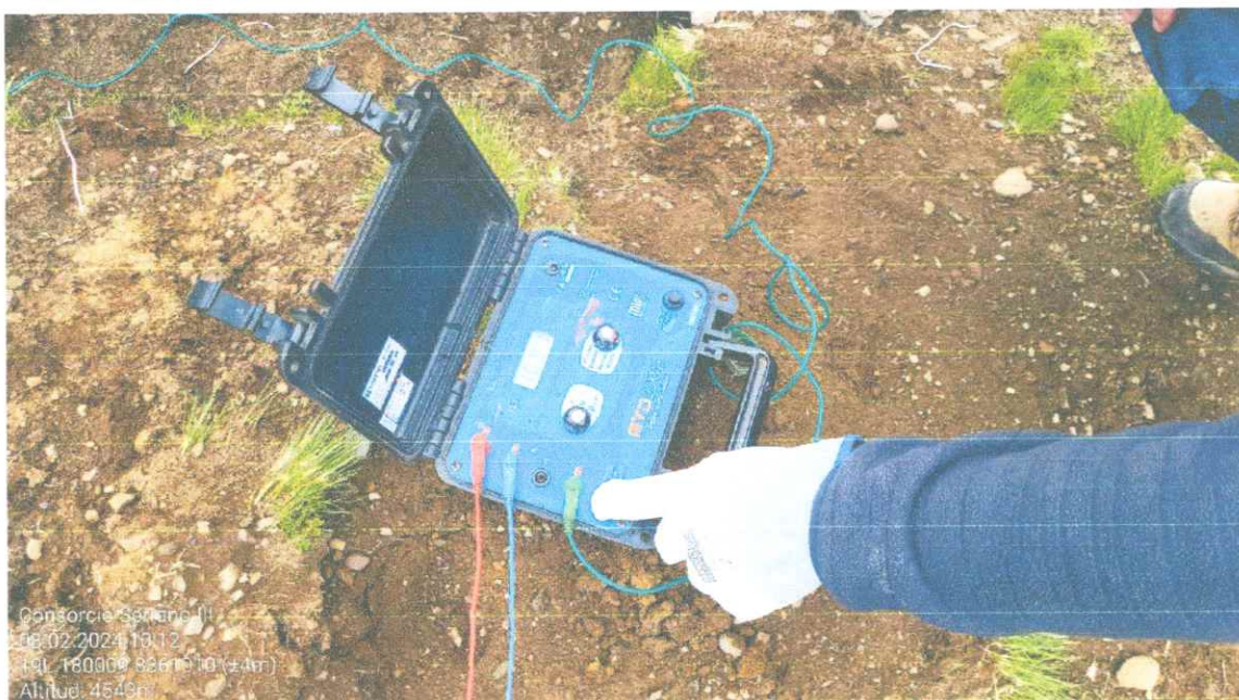
Foto N° 16: verificación de valor de las mediciones de sistema de puesta a tierra.
